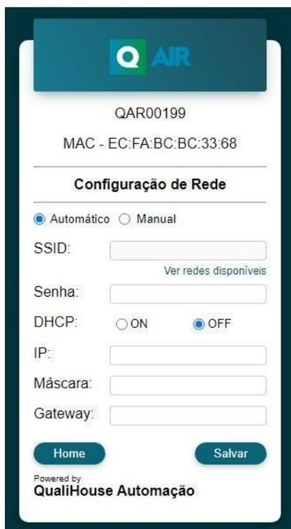
Para alterar as configurações do módulo conectado à uma rede Wi-Fi:
